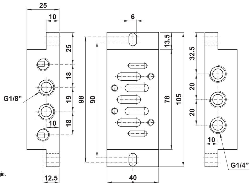
**06.001.2** : Versione adattata per installazione su cilindro ISO 6431, fornita in kit con tutti i particolari necessari al suo assemblaggio.
