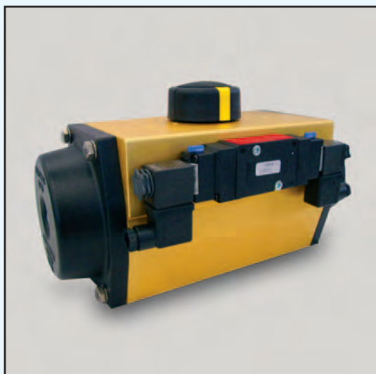
Attuatore pneumatico serie AP DA/SR con elettrovalvola NAMUR IP 65. doppio solenoide AP series DA/SR pneumatic actuator with NAMUR IP 65 bistable solenoid valve Size 1.
