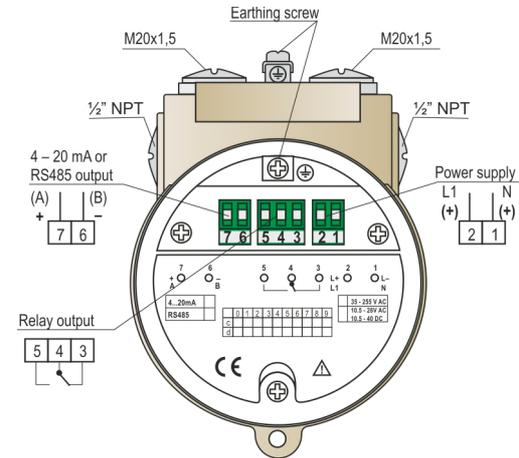
**Figure 2. Wiring diagram**
