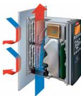
Montaža na zid, sa prinudnim strujanjem vazduha kroz hladnjak.
