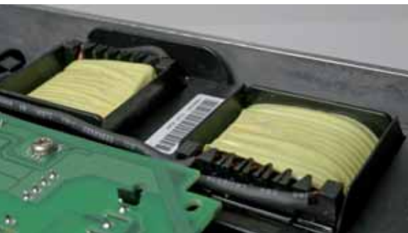
Prigušnice u jednosmernom međukolu smanjuju harmonijske smetnje i štite frekventni pretvarač.
