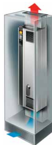
Intelligentan, specijalizovan komplet kanala omogućuje da se frekventni pretvarači sa kućištima tipa D1 i D2, montiraju u Rittalove ormara, tako da se 85% neželjene toplote odvodi strujanjem hladnog vazduha bez dodira elektronike pretvarača.
